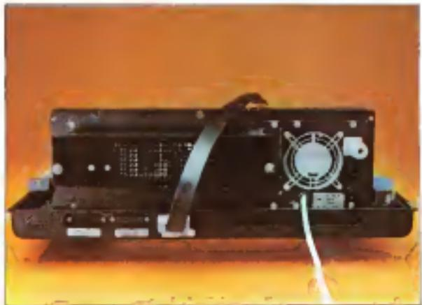
Il Quasar/M ha posteriormente in serie le tre porte di I/O, paralleli tipo Centronics RS-232 e video. Al di sotto il risultato per facilitare la disposizione del cablo collegato e delle diverse piastre connesse al sistema.
